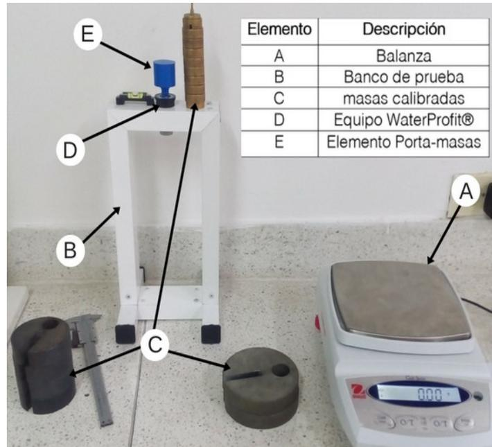
Figura 3. Montaje para medición de constante de resorte de WaterProfit®. Fuente: Propia
