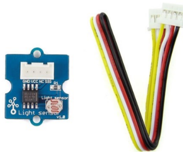
Figura 4. Módulo Grove- Light Sensor
