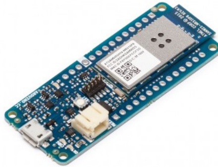
Figura 1. Módulo Arduino MKR1000
