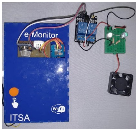
Figura 16. Sistema de Monitoreo y Control acoplado a módulo Relé, Leds y Disipador
